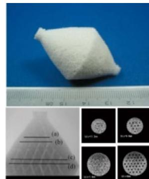
擬血管流路配備3次元臓器構築担体の積層造形
