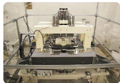
開発した超精密位置決めシステムおよび超精密切削加工システム
