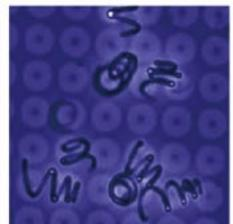
マイクロスプリングなど細胞の形を制御することで、機械システムの「部品」として利用する
