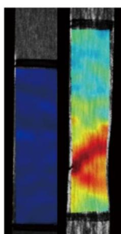
完全非接触塑性ひずみ計測
