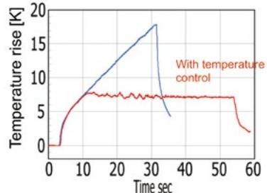
温度センサ搭載切削工具による加工中の温度制御
