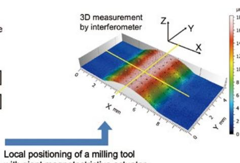
フライス加工対応高速工具サーボによる曲面上への微細構造の創成
