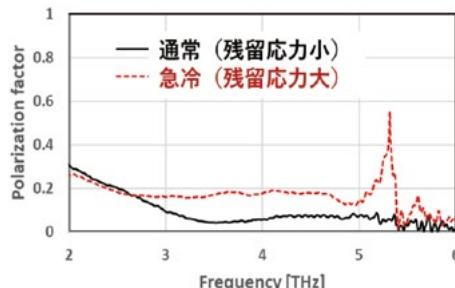
テラヘルツ偏光を利用した樹脂内部残留応力評価
