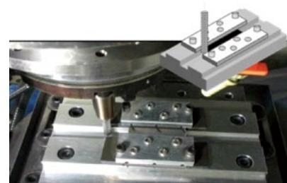
CFRP用切削工具の評価試験
