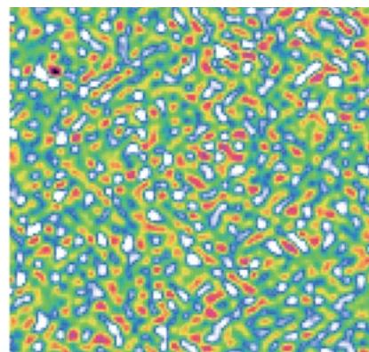
化学コントラストを有するAFMで撮像したはんだの原子分解能像
