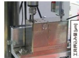
接触式工具長測定器
