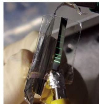
世界最薄(厚さ6ミクロン程度)の超フレキシブル有機ELデバイスを創る
