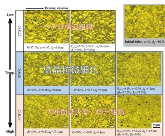
生体吸収性マグネシウム合金管の結晶組織制御
