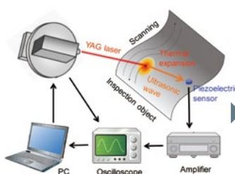
レーザー超音波可視化検査装置
