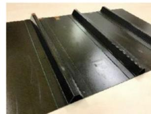
CFRP製スキン/ストリンガ構造供試体
