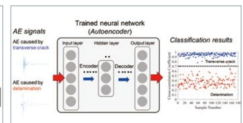
機械学習によるAE発生源の損傷形態の識別
