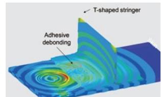
CFRP製スキン/ストリンガ接着構造
