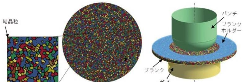
結晶粒や表面粗さを考慮したメソスケール材料モデルの微細精密プレス成形への応用
