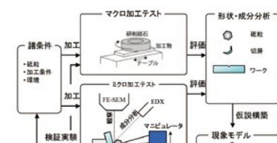
単粒切削試験による最適砥石開発のフロー
