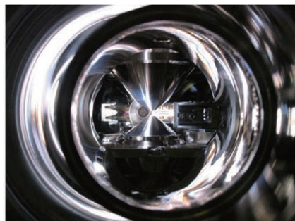
UHVTEMAFMとUHVMAFMアトムプローブ An UHV TEMA FM and an UHV AFM-atom probe
