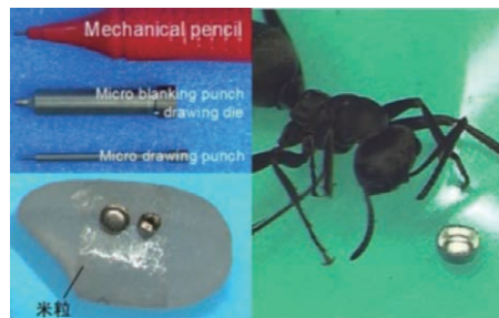
微細精密プレス成形で創製した円筒カップ Circular cup fabricated by micro metal forming
