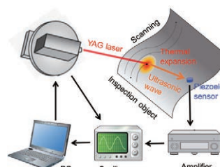
レーザー超音波可視化検査装置 (LUVI-CP, つくばテクノロジー (株)) Laser ultrasonic visualizing inspector (LUVI-CP, Tsukuba Technology Co., Ltd.)
