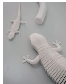
積層造形法を用いた プロトタイプ (2014)
