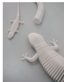
積層造形法を用いた プロトタイプ (2014)
